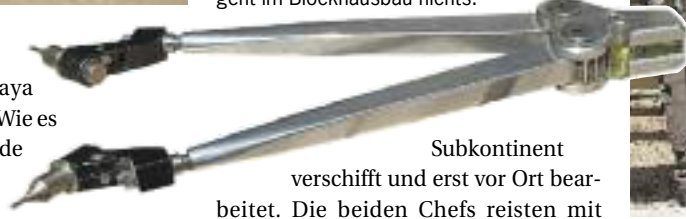
Wertvolles Helferlein: Ohne den Scriber geht im Blockhausbau nichts.
